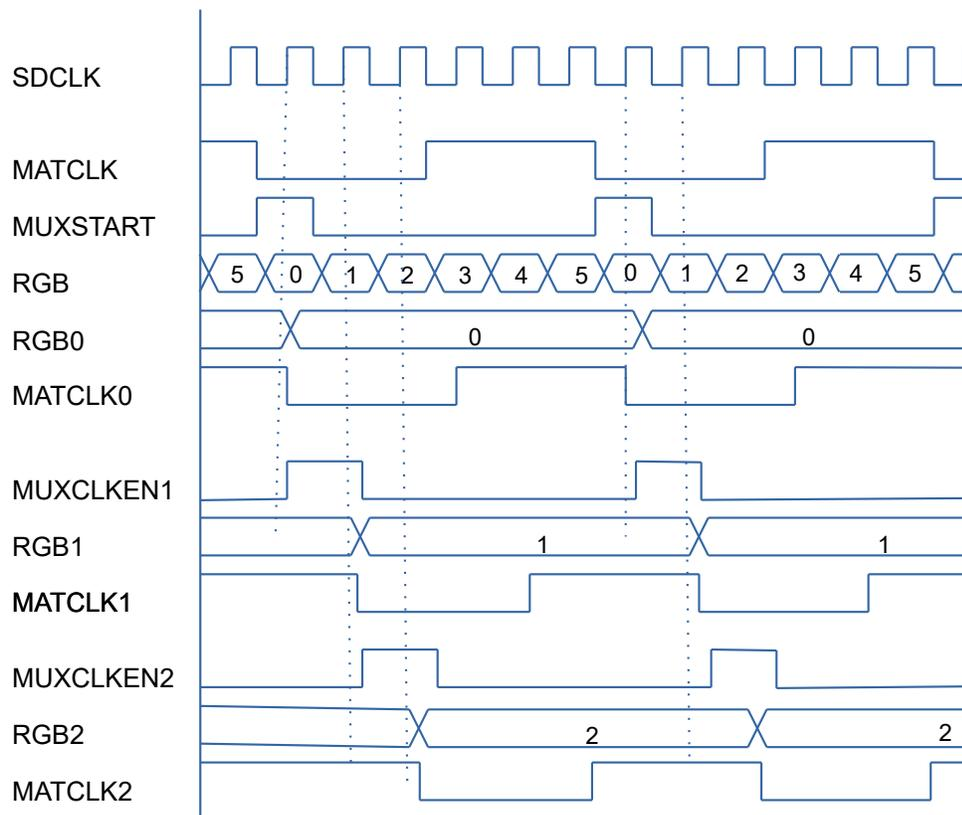
CPUが生成するMUXSTART信号から、シフトレジスタで1クロックごとにずれたパルス状のMUXCLKENx信号を5本生成します。RGB信号分配用の大量のフリップフロップは、このMUXCLKENx信号がONの時だけRGB信号を受信します。この結果、6クロックごとに6系統のRGBフリップフロップにそれぞれデータが格納されます。
