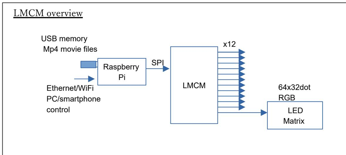
表示する画像には、基本的にはUSBメモリ上のMP4などの動画ファイルを使用します。解像度は2K程度までであれば特に制限はなく、LEDマトリックスの画面サイズに合わせて自動補正します。USBメモリはRaspberryPiのUSBポートに挿入すればデフォルトで自動再生します。
