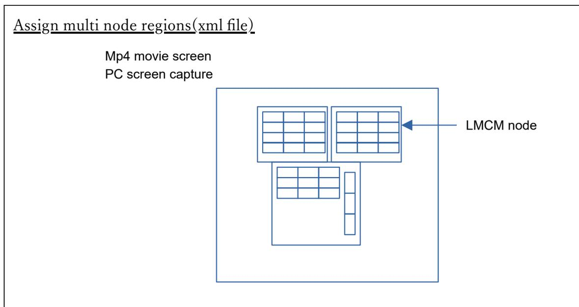
以下は設定XMLファイルの一例です。大画面に対する座標、90度単位の回転などを指定できます。設定ファイルのIPアドレスは強制指定もできますが、ネットワーク自動スキャンによるIDからの自動割り当ても可能にしました。LinuxあるいはWindowsのPythonスクリプトで起動ごとにXMLファイルを生成しています。
