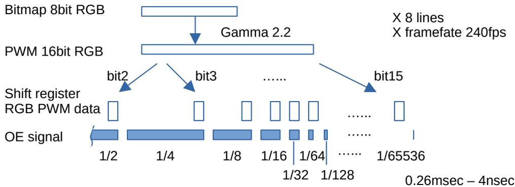
LEDマトリックスの点灯制御を行うOE信号を1/65536単位で高精度タイマーで制御します。LMCMで使用している高精度タイマーは400MHzで動作するため、2.5usecの精度でのパルスが出力可能です。
